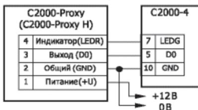
Схема подключения С2000-Proxy и С2000-Proxy H
