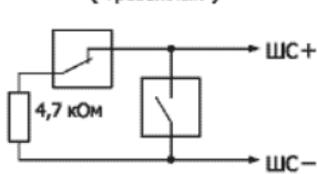
Включение охранных извещателей с блокировочными контактами в ШС типа 5 ("Охранный с контролем блокировки")
