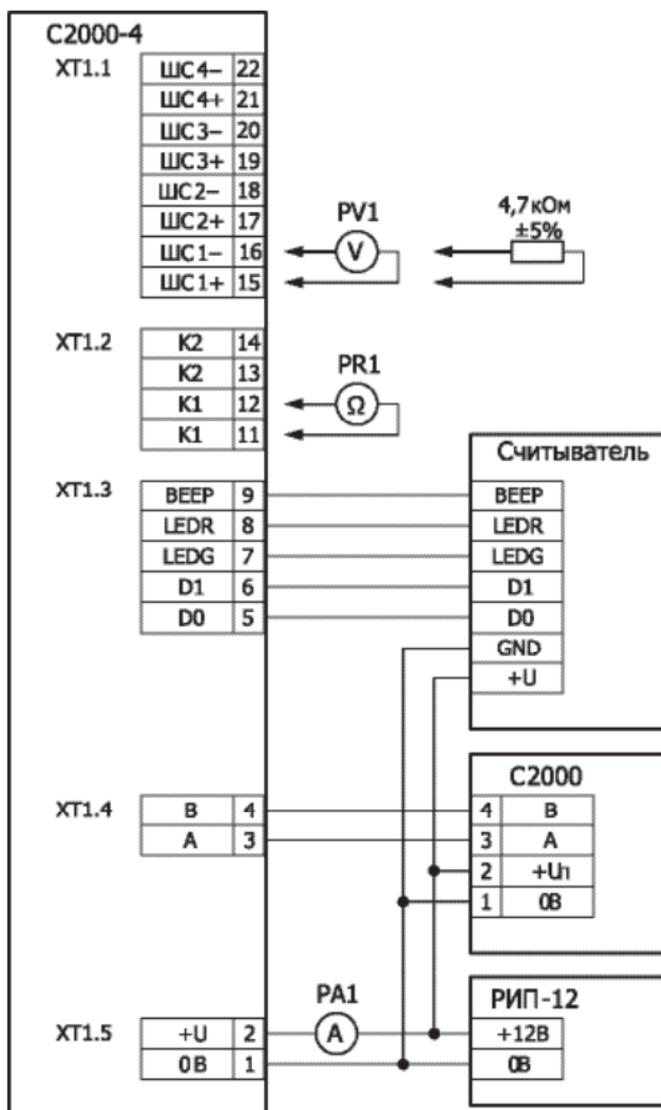
PV1, PR1, PA1 – прибор комбинированный (тестер) в режиме измерения напряжения, сопротивления и тока соответственно
