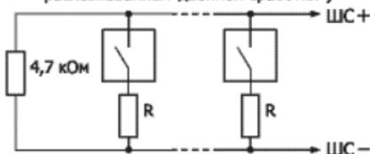
$R = 1,5 \text{ кОм} \pm 5\%$  для ДИП-ЗСУ, ДИП-У (напряжение на сработавшем извещателе от 7,5 до 8,5 В)
