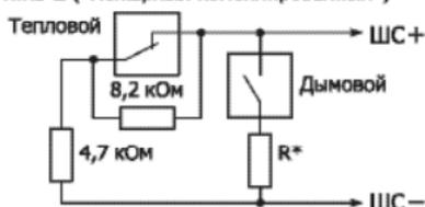
$R^* = 0$  для ДИП-ЗМ, ДИП-ЗСУ, ДИП-У, 2100, 2151Е (напряжение на сработавшем извещателе  $> 4\text{В}$ )
